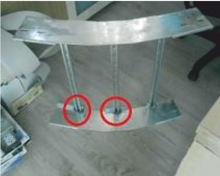
Kaynak bölgesinde galvanizlenmemiş alan
