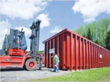
Los tanques de KVK están contruidos con una construcción especial de paneles sándwich que tienen: Un núcleo de cerámica sintética resistente a los impactos, revestido en ambos lados con laminados reforzados con fibra para formar una pieza inseperable.
