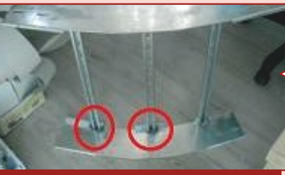
Kaynak sırasında yanmış yağ
