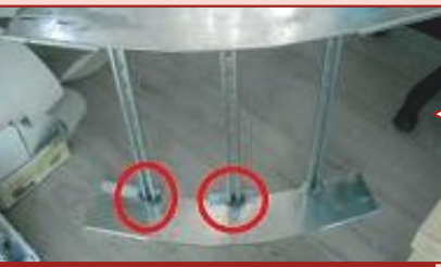
Kaynak sırasında yanmış yağ
